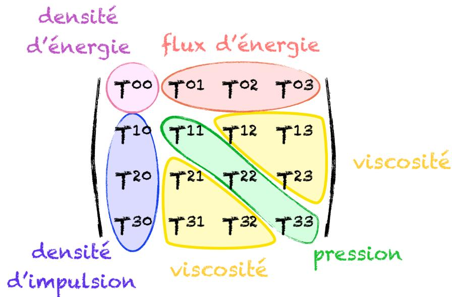
Par analogie avec le tenseur des contraintes des milieux continus, on peut reconnaître des pressions dans les termes  $T^{ii}$  et une viscosité de cisaillement, dans les termes  $T^{ij}, i \neq j$ .
