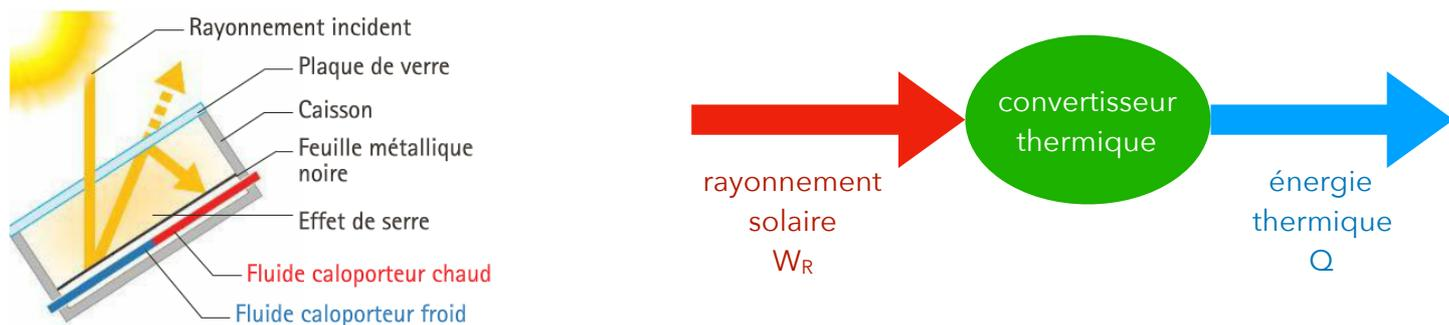
Captteur solaire thermique (le rayonnement diffusé par la feuille noire est un rayonnement thermique infrarouge piégé par le verre contrairement au rayonnement incident plus énergétique, c'est l'effet de serre).
